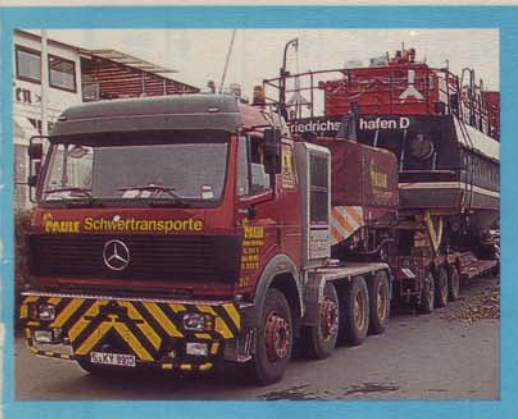
Spezialtieflader transportierten die 23 Meter langen und 53 Tonnen schweren Boote von Plochingen nach Friedrichshafen.
