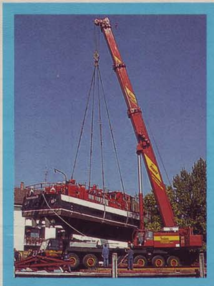
Die Stahlseile werden angebracht, um das 53-Tonnen-Fahrzeug ins Wasser zu heben.
